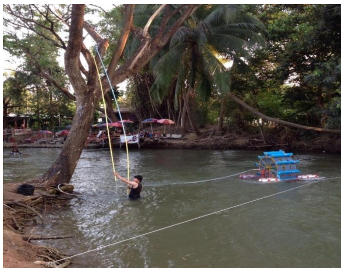
รูปที่ 3 การทดสอบเครื่องสูบน้ำแบบชุดเกลียวที่แม่น้ำวังเนร
