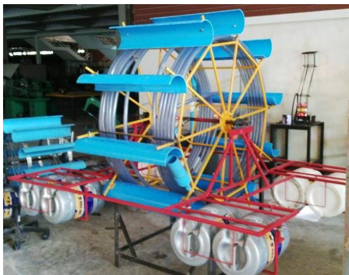
รูปที่ 2 เครื่องสูบน้ำแบบขดเกลียวที่สร้างขึ้นสำหรับทดสอบการใช้งาน
