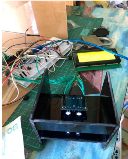
รูปที่ 8 โครงสร้างของเครื่องรับธนบัตร
