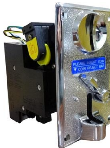
รูปที่ 7 โครงสร้างของเครื่องรับเหรียญ
