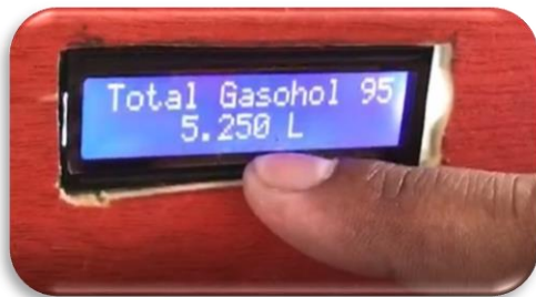
รูปที่ 5 การแสดงผลปริมาณน้ำมันคงเหลือขณะจำหน่าย
