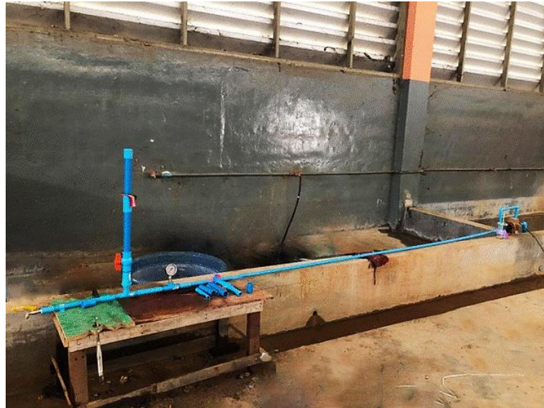
รูปที่ 1 แบบจำลองชุดทดสอบผลกระทบจากการเกิดค้อนน้ำ ด้วยถังลดความดัน
