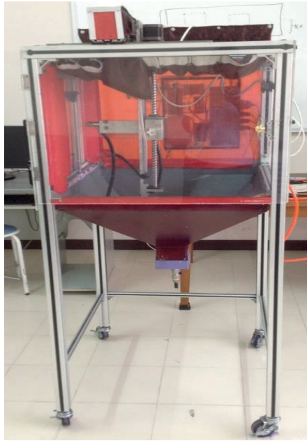
รูปที่ 4 เครื่องพ่นทรายอัลตราโซนิกขนาดเล็ก ที่มา: จุฑาทิพย์ ทองเดชาสามารถ และ ชัยนิกร กุลวงษ์ (2556: 35)
