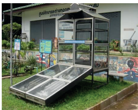
รูปที่ 2 ตู้อบแห้งแบบการพาความร้อน ที่มา: ไพบุลย์ ธรรมรัตนवासิก, (2532)
