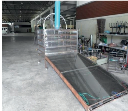
รูปที่ 6 ตู้อบกล้วยพลังงานแสงอาทิตย์ที่สร้างขึ้นสำหรับการทดสอบ
