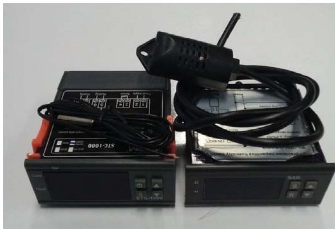
ภาพ 2 เซนเซอร์วัดค่าความชื้นและอุณหภูมิ ที่ใช้กับงานต้นแบบเทคโนโลยีการอบแห้ง แบบป้องกันรังสีพลังงานแสงอาทิตย์ต้นทุนต่ำสำหรับ กลุ่มวิสาหกิจชุมชนกลุ่มดวงทอง จังหวัดเพชรบูรณ์
