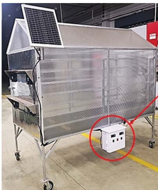
ภาพ 5 ต้นแบบเทคโนโลยีการอบแห้งแบบป้องกันรังสีพลังงานแสงอาทิตย์ต้นทุนต่ำ สำหรับกลุ่มวิสาหกิจชุมชนกลุ่มดวงทอง จังหวัดเพชรบูรณ์
