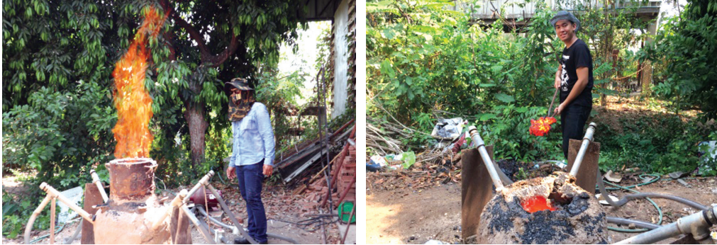
รูปที่ 6 แสดงแร่เหล็กที่ถลุงแร่ด้วยเตาถลุงแบบผสมผสาน
