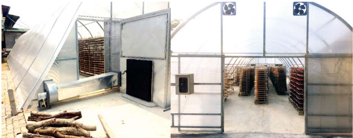
ภาพที่ 4 เครื่องอบแห้งข้าวแต๋นที่ใช้พลังงานความร้อนจากแสงอาทิตย์ร่วมกับชีวมวล
