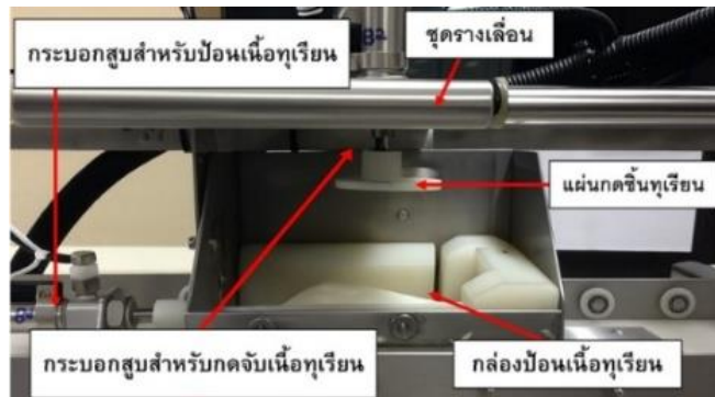
ภาพ 3 ชุดอุปกรณ์ที่เกี่ยวข้องกับการแปรรูปเนื้อทุเรียนแบบแท่ง
