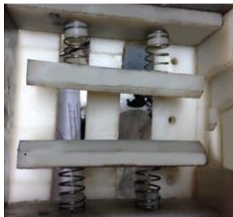
ภาพ 14 การติดตั้งชุดสปริงเสริมด้านข้างในกล่องป้อนเนื้อทุเรียน
