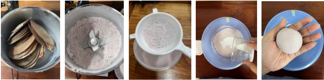
ภาพ 1 วิธีการทำดินปั้นจากเปลือกหอยเชลล์ฝาดแห้ง
