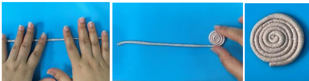
ภาพ 2 การขึ้นรูปเพื่อทดสอบคุณภาพดินปั้นจากเปลือกหอยเชลล์ฝาดแห้งด้วยวิธีการปั้นเป็นรูปก้นหอย
