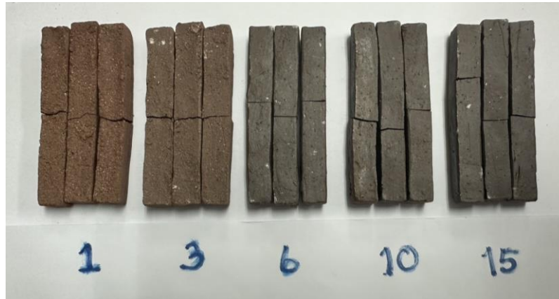
ภาพ 1 แท่งทดสอบเนื้อดินที่ผ่านการเผาอุณหภูมิ 1,220 องศาเซลเซียส
