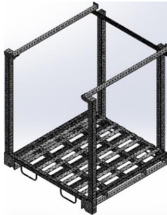
ภาพ 2 การแบ่งแบบจำลองพลาเทหลักออกเป็นเอลิเมนต์สามมิติ
