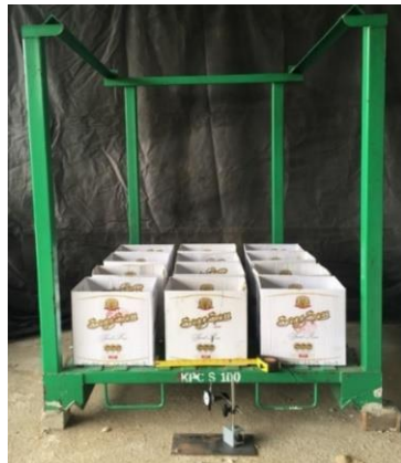
(ก) การทดสอบระยะการแอ่นของพาเลทเหล็ก
