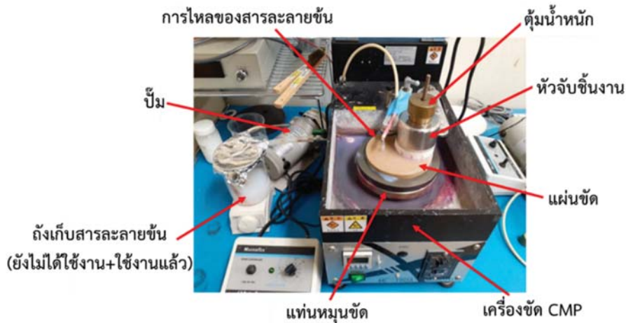
รูปที่ 2 เครื่องขัดผิวชิ้นงานด้วยกระบวนการใช้สารเคมีร่วมกับแรงทางกล
