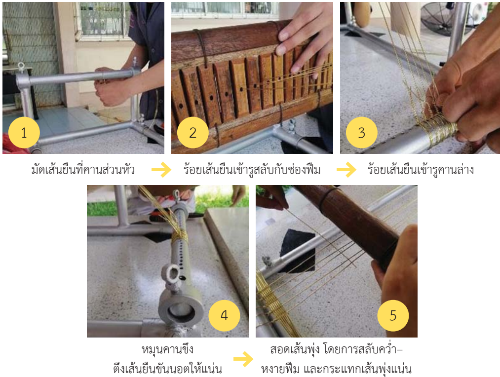
รูปที่ 4 วิธีการใช้งานเครื่องทอโลหะ
