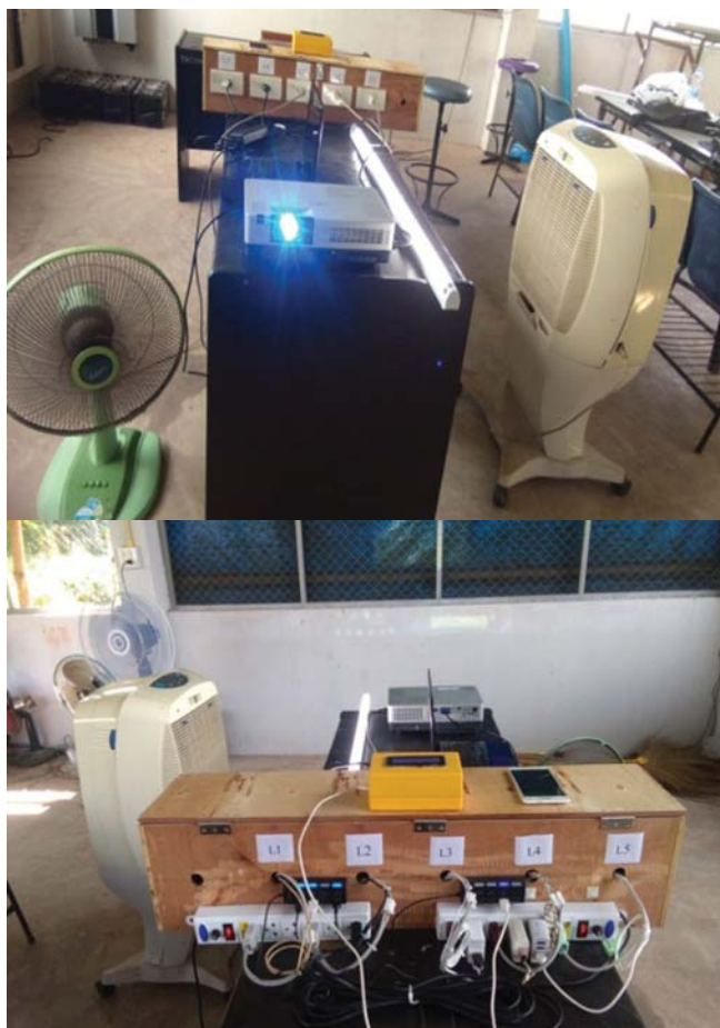
รูปที่ 4 วงจรไฟฟ้าเข้ากับสมาร์ตมิเตอร์ที่ใช้ในการหาประสิทธิภาพ
