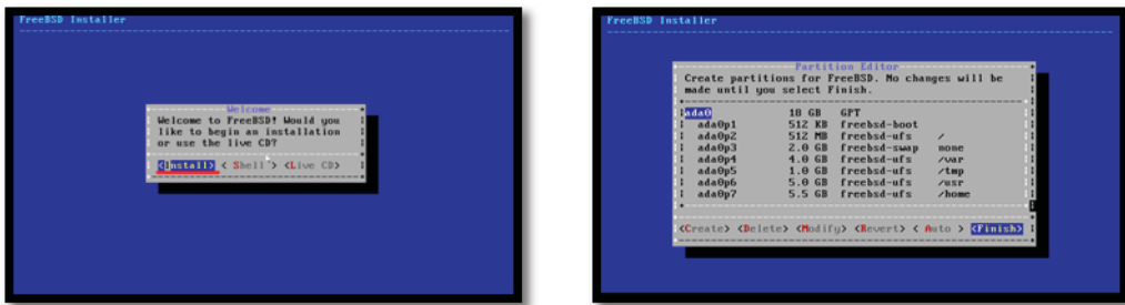
ภาพที่ 6 แสดงการแบ่ง Partition ในเครื่องแม่ข่ายคอมพิวเตอร์
