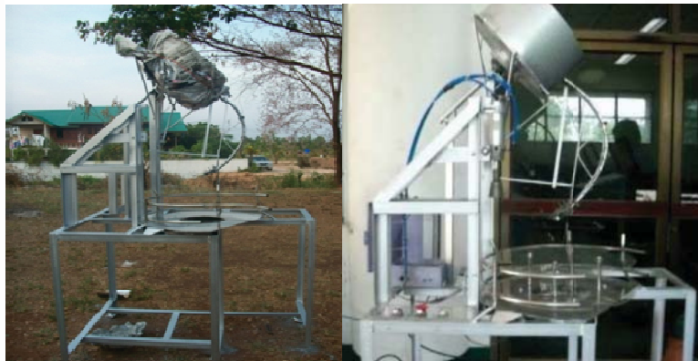
ภาพที่ 1 โครงสร้างการออกแบบและส่วนประกอบเครื่องปิดฟาจีบอัตโนมัติ
