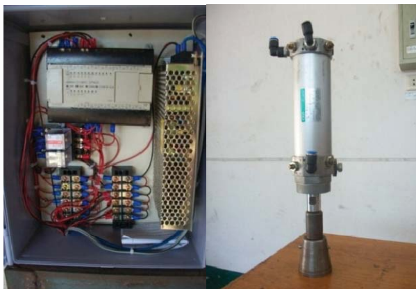
ภาพที่ 2 ระบบควบคุมเครื่องปิดฝาจีบอัตโนมัติ และ ชุดกระบอกสูบนิวแมติกปิดฝาจีบ
