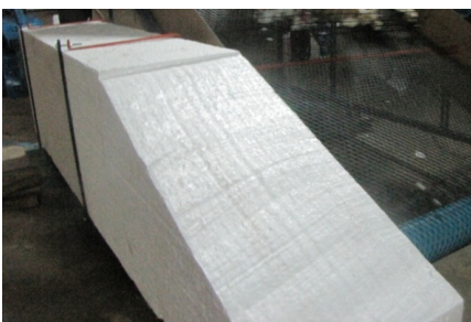
ภาพที่ 6 โฟมที่ใช้ทำหุ่นเรือเก็บขยะ
