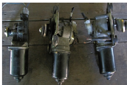
ภาพที่ 10 มอเตอร์ไฟฟ้ากระแสตรง
