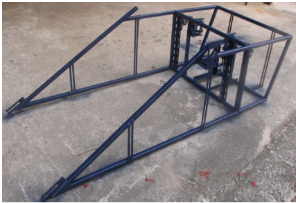
ภาพที่ 2 โครงสร้างเรือเก็บขยะ
