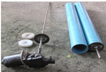
ภาพที่ 3 ท่อที่ใช้ทำแกนหมุนสายพานลำเลียงขยะ
