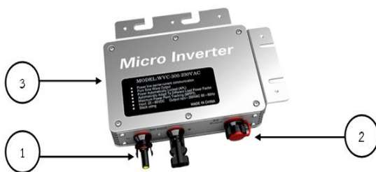
รูปที่ 1 ไมโครอินเวอร์เตอร์ขนาด 300 วัตต์ DXM 300
