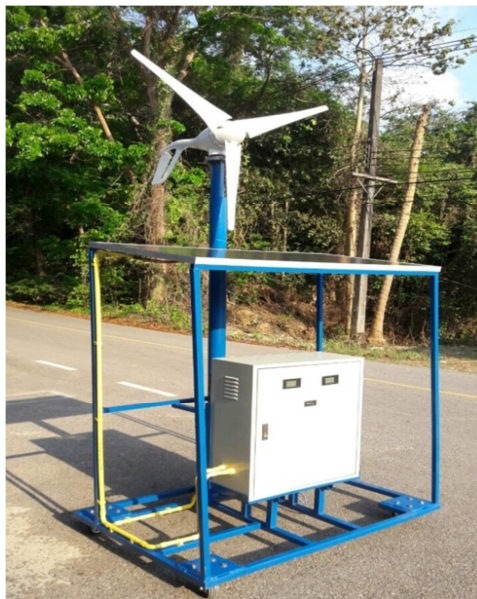
รูปที่ 3 โครงสร้างระบบกังหันลมร่วมกับพลังงานแสงอาทิตย์ผลิตกระแสไฟฟ้า
