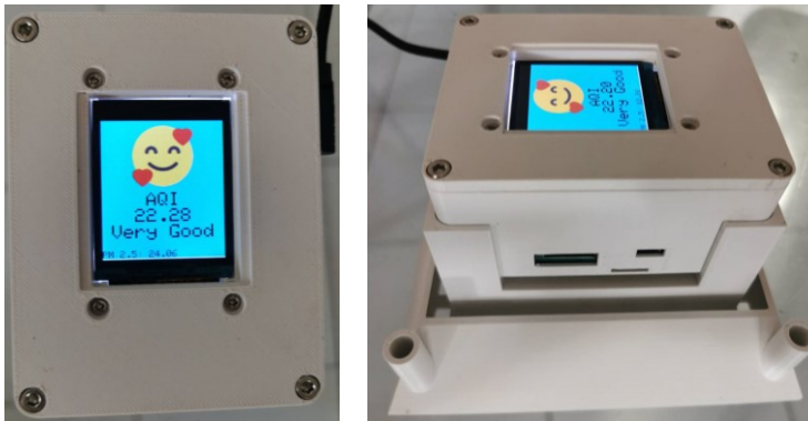
รูปที่ 4 ชุดอุปกรณ์ตรวจวัดค่าฝุ่นละอองสำหรับใช้ภายในและภายนอกอาคารรุ่นที่ 2
