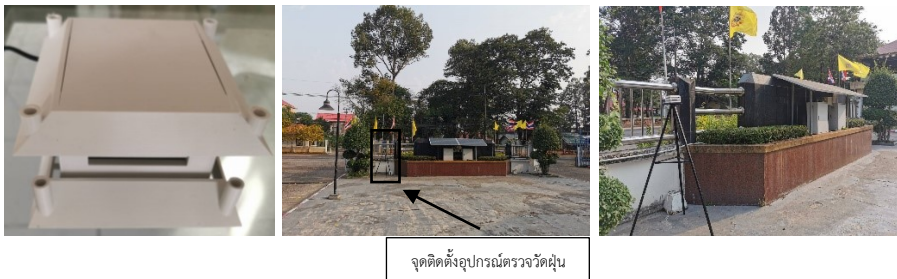
รูปที่ 5 ชุดอุปกรณ์สวกรอบเครื่องวัดค่าฝุ่นละอองสำหรับใช้ภายนอกอาคาร และตำแหน่งติดตั้งอุปกรณ์ตรวจวัดค่าฝุ่นละอองภายนอกแบบชั่วคราว
