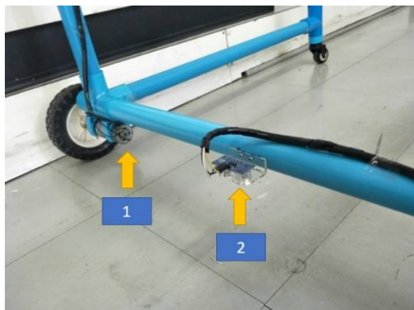
รูปที่ 7 การติดตั้งอุปกรณ์ของเครื่องช่วยเดิน (1) มอเตอร์ไฟฟ้ากระแสตรง
