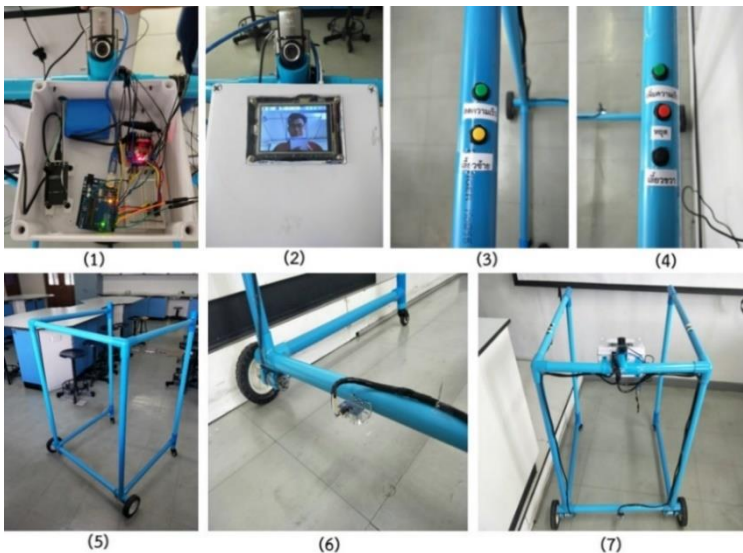
รูปที่ 4 การประกอบเครื่องมือและอุปกรณ์ของเครื่องช่วยเดินสำหรับผู้สูงอายุ
