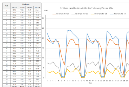
รูปที่ 13 ข้อมูลและกราฟแสดงปริมาณการใช้พลังงานไฟฟ้าของแต่ละห้องทำงาน
