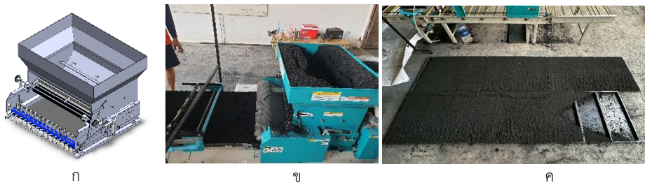
รูปที่ 2 แสดงการทดสอบหาความสม่ำเสมอในการโรยวัสดุเพาะ (ก) ลักษณะของชุดโรยวัสดุเพาะ (ข) ลักษณะการโรยวัสดุเพาะลงในถาด (ค) ลักษณะถาดที่โรยวัสดุเพาะแล้ว
