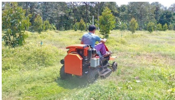
รูปที่ 5 การใช้งานรถตัดหญ้านั่งขับเคลื่อนที่ด้วยระบบไฮดรอลิกในพื้นที่แปลงเกษตร
