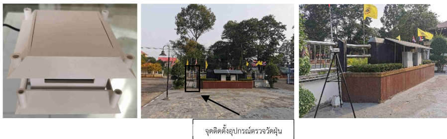
รูปที่ 5 ชุดอุปกรณ์สวบครอบเครื่องวัดค่าฝุ่นละอองสำหรับใช้ภายนอกอาคาร และตำแหน่งติดตั้งอุปกรณ์ตรวจวัดค่าฝุ่นละอองภายนอกแบบชั่วคราว
