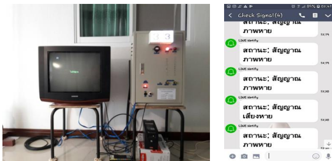
รูปที่ 13 การทดสอบเมื่อไม่มีสัญญาณภาพจะแจ้งเตือนบนแอปพลิเคชันไลน์
