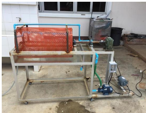
รูปที่ 8 เครื่องล้างทำความสะอาดหัวฆ่าที่ใช้ในการทดสอบ
