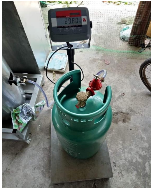
รูปที่ 5 การชั่งน้ำหนักถังแก๊สปิโตรเลียมเหลวเพื่อทดสอบหาปริมาณการใช้แก๊สเชื้อเพลิง
