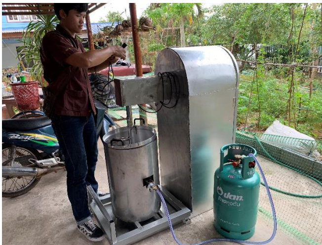
รูปที่ 2 เครื่องกวนไส้ขนมกะหรี่ปั๊บนิดให้ความร้อนด้วยแก๊สปิโตรเลียมเหลวที่พัฒนาขึ้น สำหรับใช้ในวิสาหกิจชุมชน
