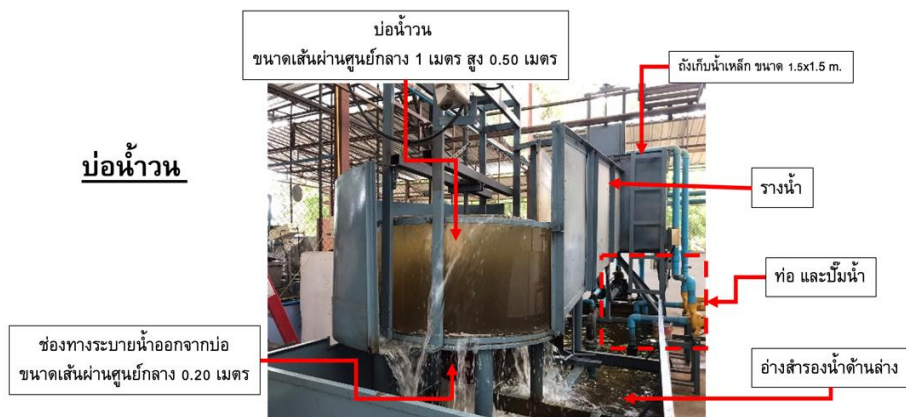
รูปที่ 1 ต้นแบบระบบผลิตกระแสไฟฟ้าพลังงานน้ำวน ที่มา: Wanchat & Suntivarakorn (2011)
