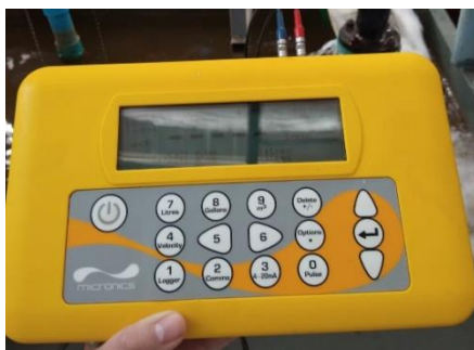
รูปที่ 4 เครื่องมือวัดการไหลแบบอัลตราโซนิก (ultrasonic flow meter)
