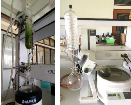
รูปที่ 2 เครื่องซอล์กลีทและเครื่องระเหยแบบสุญญากาศ
