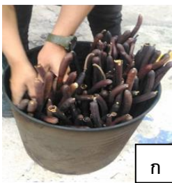
รูปที่ 4 แสดงการเตรียมวัตถุดิบ (ก) ฝักราชพฤกษ์ก่อนเผา (ข) ถ่านฝักราชพฤกษ์หลังเผา (ค) ผงถ่านฝักราชพฤกษ์ที่ผ่านการบด
