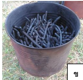
รูปที่ 4 แสดงการเตรียมวัตถุดิบ (ก) ฝักราชพฤกษ์ก่อนเผา (ข) ถ่านฝักราชพฤกษ์หลังเผา (ค) ผงถ่านฝักราชพฤกษ์ที่ผ่านการบด
