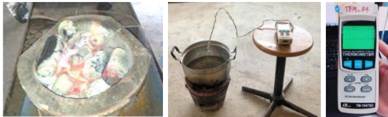
รูปที่ 6 แสดงอุปกรณ์ที่ใช้บันทึกอุณหภูมิและการบันทึกอุณหภูมิ
