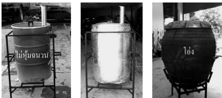
รูปที่ 2 การติดตั้งเตาถ่านเข้ากับเตาอบไก่อ่
