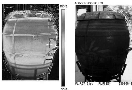
รูปที่ 11 ภาพถ่ายทางความร้อนภายในเตาอบ และผิวของเตาอบโอ่ง
