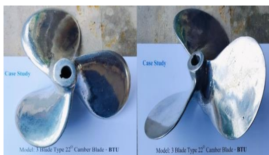
รูปที่ 13 Model ใบจักรแบบใหม่ 3 ปีก มุมโค้ง 22°
