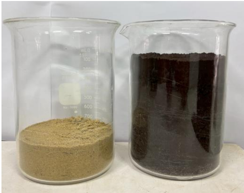
(ก) แสดงปริมาตรของทราย และกากกาแฟที่ต่างกันเมื่อน้ำหนัก 300 กรัม ทรายมีปริมาตร 392.7 ลบ.ซม. กากกาแฟมีปริมาตร 863.94 ลบ.ซม
