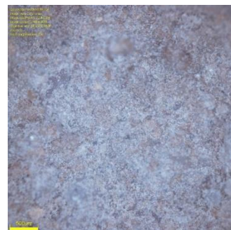
(ข) ภาพถ่ายขยายมอร์ตาร์ผสมกากกาแฟ ขนาด 500 เท่า
