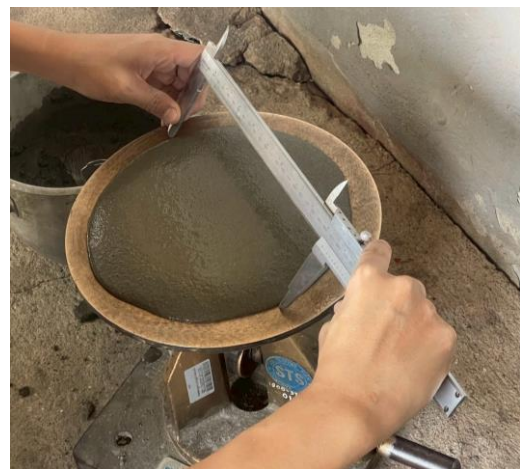
รูปที่ 2 ทดสอบการไหลตามมาตรฐาน ASTM C230
