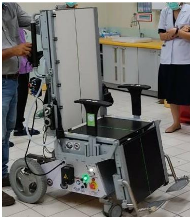
รูปที่ 5 รถเข็นเอกซเรย์ที่สามารถปรับทำนั่งเป็นท่านอนได้เพื่อลดการสัมผัสผู้ป่วย [7]
