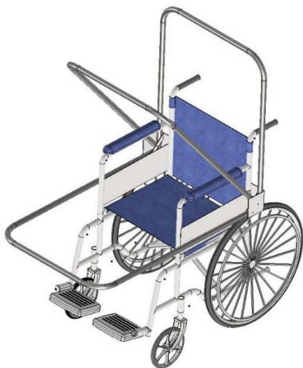
รูปที่ 20 ชุดโครงสร้างวีลแชร์ที่ติดตั้งโครงครอบผู้ป่วย
