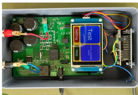
รูปที่ 10 ภาพถ่ายจริงเครื่องตรวจวัดคุณลักษณะกระแส-แรงดันแผงเซลล์แสงอาทิตย์ที่นำเสนอ
