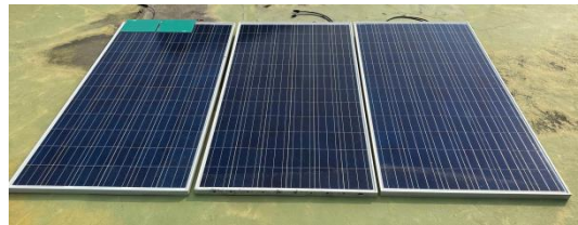
รูปที่ 19 ภาพถ่ายการทดสอบขณะบางส่วนของแผงเซลล์แสงอาทิตย์ถูกเงาบัง 100% ด้วยแผ่นทึบ
