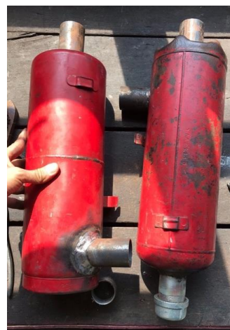
รูปที่ 5 แสดงภาพตัวกรองแบบละเอียด (หน่วย เซนติเมตร)
