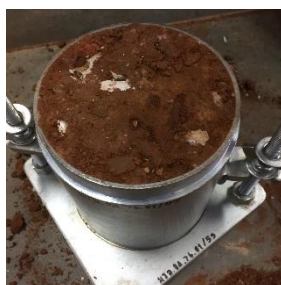
รูปที่ 4 การทดสอบการบดอัดดินของดินภูเขา
