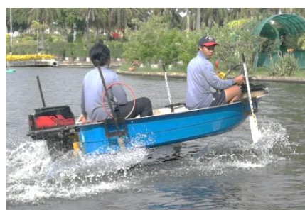
รูปที่ 11 อองสามมุมปะทะฟอยล์ที่ 14^\circ
