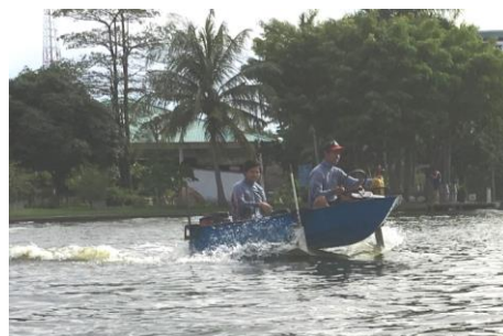
รูปที่ 10 อองสามมุมปะทะฟอยล์ที่ 12^\circ
