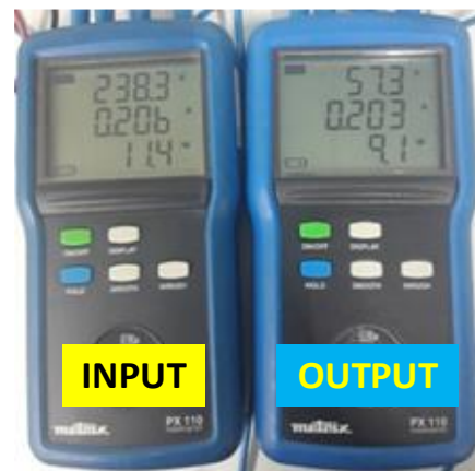
รูปที่ 13 ค่าที่ได้จากการวัดแรงดัน กระแส และกำลังทั้งทางด้านเข้าและด้านออกที่มุมทริก 144^\circ
