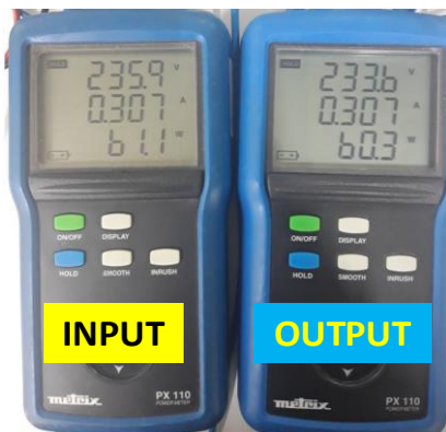
รูปที่ 10 ค่าที่ได้จากการวัดแรงดัน กระแส และกำลังทั้งทางด้านเข้าและด้านออกที่มุมทริก 18^\circ
