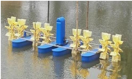
รูปที่ 5 ลักษณะของเครื่องเติมอากาศแบบ Paddle Wheel ที่มีใช้กันอยู่ทั่วไป [8]
