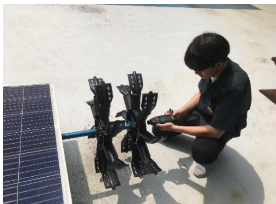
รูปที่ 3 กังหันเครื่องเติมอากาศและ การวัดความเร็วรอบขณะ No load
