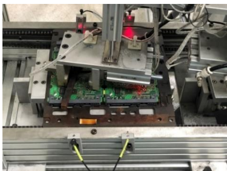
รูปที่ 4 แสดงการหยิบชิ้นงานของแขนกล
