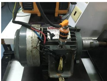
รูปที่ 10 ติดตั้งอุปกรณ์ตรวจวัดการสั่นสะเทือนให้กับมอเตอร์ไฟฟ้าเหนี่ยวนำ
