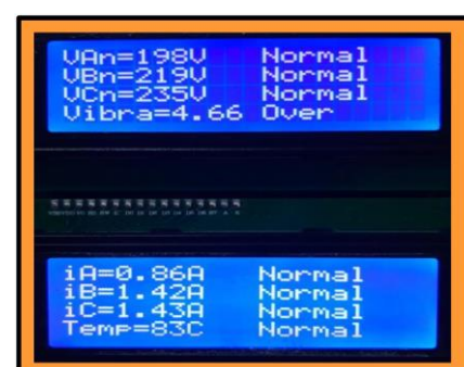
รูปที่ 12 แสดงผลสภาวะเกิดการสั่นผิดปกติบนจอ LCD
