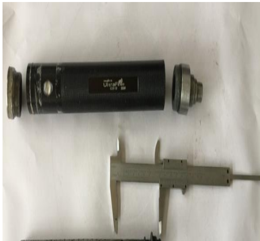
รูปที่ 16 หลอดคลดเสียงทำจากกระบอกไฟฉายยาว 25.4 cm เส้นผ่านศูนย์กลาง 3.4 cm ทดสอบกับกรวยก้นผนัง 1 ห้อง
