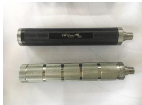
รูปที่ 4 หลอดลดเสียงทำจากกระบอกไฟฉาย
