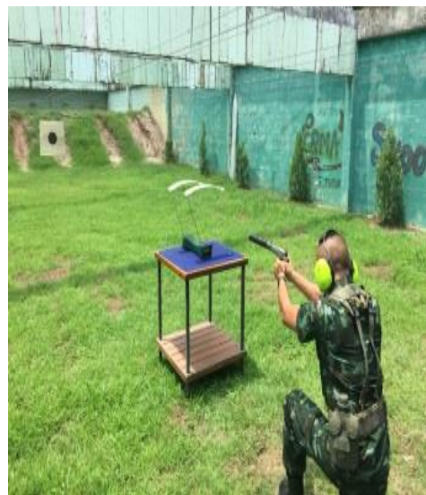
รูปที่ 20 การยิงทดสอบบันทึกความดังเสียง ละความเร็วต้น
