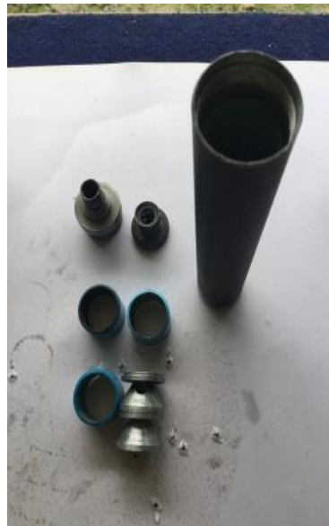
รูปที่ 19 หลอดลดเสียงทำจากกระบอกไฟฉายและผนัง กันรูปกรวยขนาด 3.4 cm
