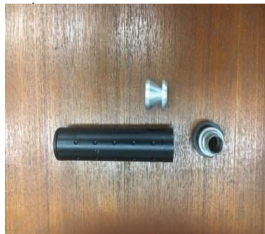
รูปที่ 13 ภาพเครื่องวัดความเร็วคันของกระสุนปืน
