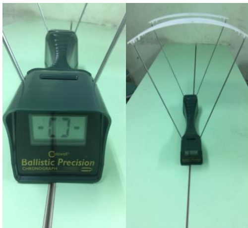
รูปที่ 13 ภาพเครื่องวัดความเร็วคันของกระสุนปืน
