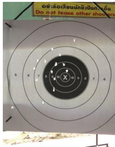
รูปที่ 24 กลุ่มกระสุนเมื่อยิงทดสอบ ด้วยปืนติดตั้งหลอดลดเสียง
