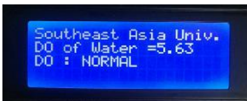
ภาพที่ 12 เป็นข้อความต่างๆ ที่หน้าจอ LCD เมื่อปริมาณค่าดีไอ ที่ทดสอบมีค่ามากกว่าหรือเท่ากับ 5 มก./ล. แต่ไม่เกิน 6 มก./ล.
