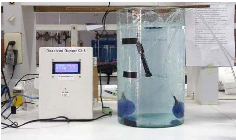
ภาพที่ 9 การตรวจวัดปริมาณ ออกซิเจนละลายน้ำโดยใช้ชุดแจ้งเตือนปริมาณออกซิเจนละลายน้ำ
