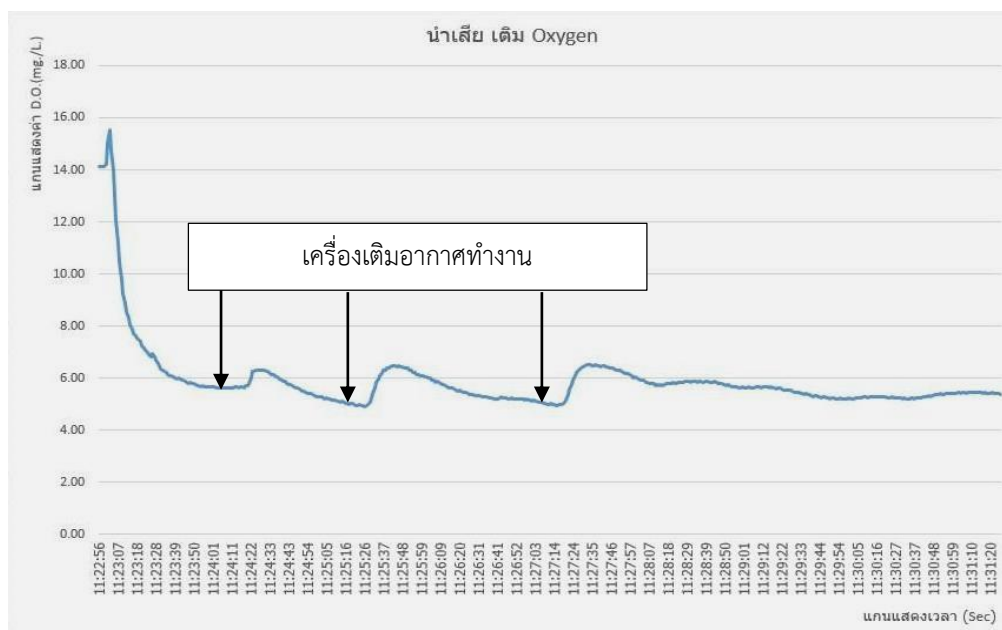
ภาพที่ 15 กราฟแสดงปริมาณออกซิเจนที่ตรวจวัดได้เมื่อทำการใช้งานชุดเครื่องเติมปริมาณออกซิเจนละลายน้ำ
