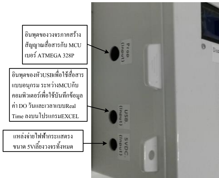
ภาพที่ 7 ส่วนของอินพุตภาคแหล่งจ่ายไฟฟ้าขนาด 5 V อินพุตภาคสื่อสารกับคอมพิวเตอร์ และอินพุตของวงจรภาคสร้างสัญญาณสื่อสารกับไมโครคอนโทรลเลอร์
