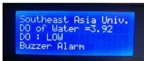
ภาพที่ 10 เป็นข้อความต่างๆ ที่หน้าจอ LCD เมื่อปริมาณค่าดีไอ ที่ทดสอบมีค่าต่ำกว่า 4 มก./ล.
