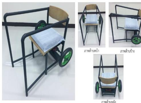
ภาพที่ 6 ภาพอุปกรณ์ช่วยยืนแบบที่ 2 หลักการของแม่แรงยก
